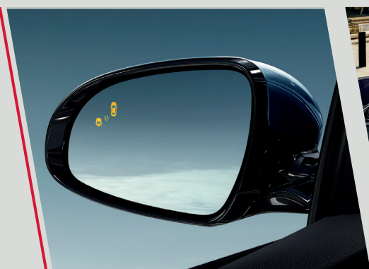
Sensores do detector de ponto cego (BSD), alertam aproximações de veículos através de sinais sonoros
