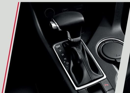
Transmissão automática de 6 velocidades com possibilidade de trocas sequenciais
