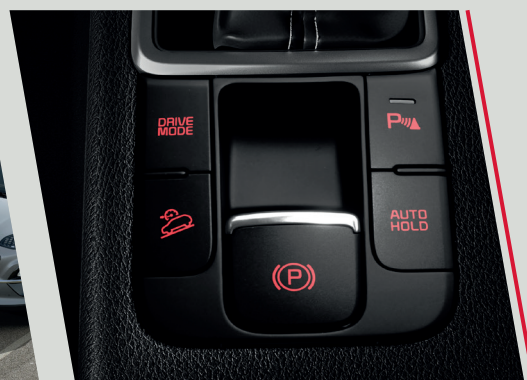
Freio de estacionamento eletrônico (EPB), com essa tecnologia o veículo é estacionado de forma rápida e segura
